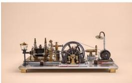
Maquette d'une machine à vapeur de Sulzer à double action et à courant continu commandée par vanne, 1990.
