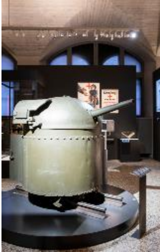
Canon à tir rapide de 5,3 cm avec affût mobile, 1892, Grusonwerk, Magdebourg. Acier.
