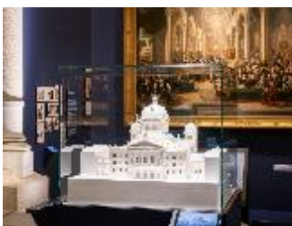
Modellino del palazzo del Parlamento, scala 1 :100, Fabricato da: Zaborowsky Modellbau, Zurigo. Vetro acrilico PVC, fresato con CNC e stampato a iniezione.
