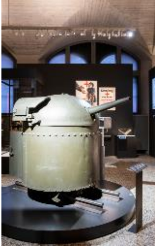
Cannone a tiro rapido da 5,3 cm con affusto mobile, 1892, Grusonwerk, Magdeburgo. Acciaio.
