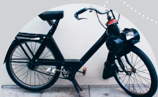
Voilà, un vélo muni d'un moteur auxiliaire ! Cherche le moteur, le réservoir, l'échappement et les phares.
